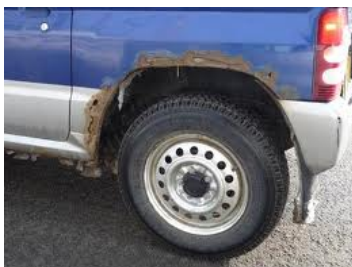
塩化カルシウム等による錆び
